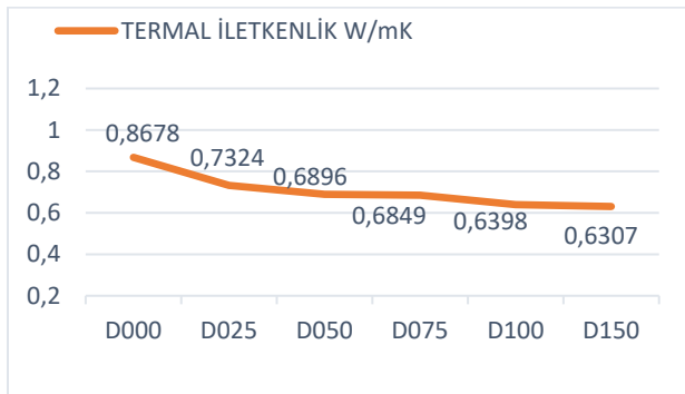
Şekil 3.9 Silikona diatomit katkısına bağlı olarak termal iletkenlik katsayısı değerlerinin değişimi.
