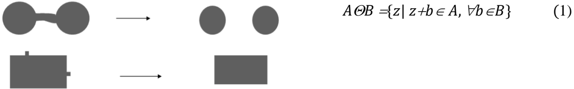
Şekil 2 : Aşınma İşlemi (Erosion)
