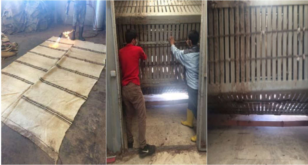
Resim.4-(solda) Halı tüylerinin alev tabancası ile yakılması
